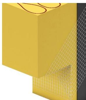
zur Ausbildung von Diagonalbewehrungen an Mauerwerksöffnungen und gleichzeitiger Leibungsarmierung mit Diagonalarmierung
