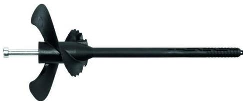
Schraubdübel mit Schraubschraube zur versenkten Montage in HECK EPS-Dämmplatten, die Öffnung im Dämmstoff ist mit Illbruck Pistolenschäum B1 zu Verschließen
