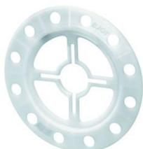
Zusätzlicher Dübelteller, Durchmesser 90 mm für die Verdübelung vom HECK MW-Dämmplatten 035/036 unter dem Gewebe in Verbindung mit HECK Schraubdübel STR-U 2G
