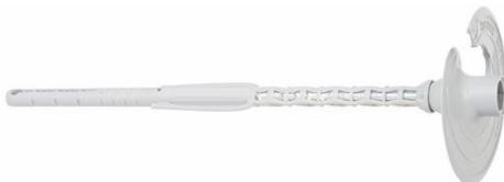
Schraubdübel mit Schraubschraube zur versenkten Montage in HECK EPS-Dämmplatten, die Öffnung im Dämmstoff ist mit Illbruck Pistolenschäum B1 zu Verschließen
